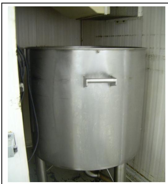
Figura 3 - Tanque de Fusão dentro da estufa
